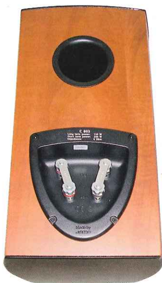
Nicht ganz optimal: Die Biwiringbrücken verhindern das Einstöpseln von Bananensteckern und sollten durch festzuklemmende Kabelbrücken ersetzt werden.
