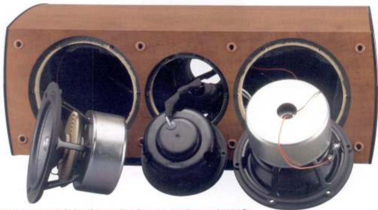
Remarquez, au centre de la photo, le capot qui sert de support «amortisseur» au tweeter. On aperçoit également, sur le boomer de droite, les deux fils qui permettent le fonctionnement du «système de correction active d'impédance» (AIC).
